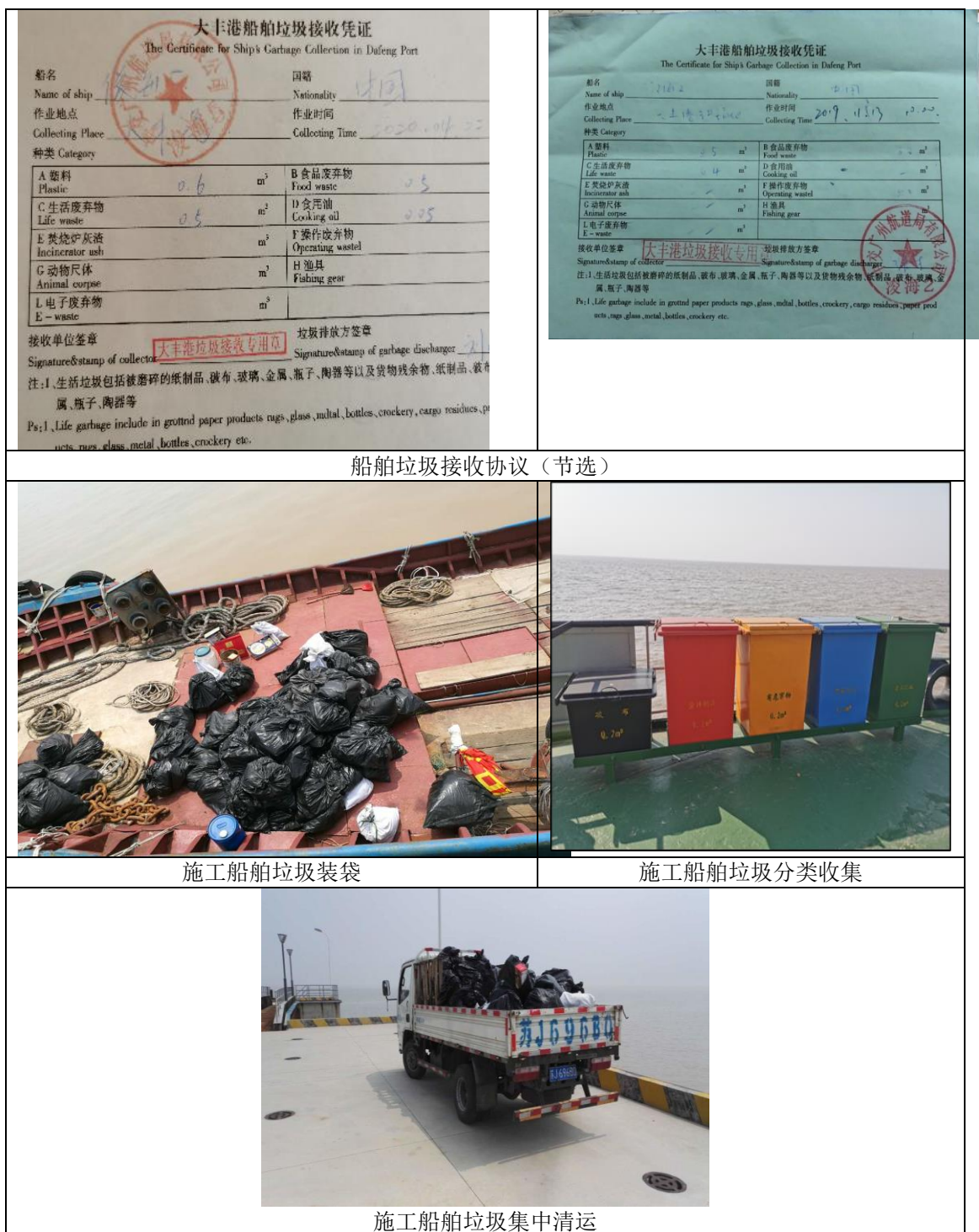
图 4.2-2 垃圾处理接收凭证、船舶垃圾袋装分类和集中清运
