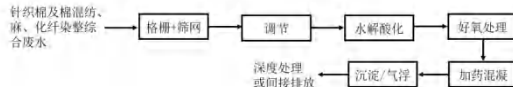
图 7.1-4 化纤染整的综合废水常规处理工艺流程示意图（HJ471-2020）
