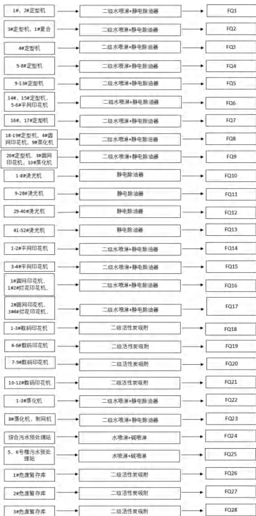
图 7.2-1 改建印染项目废气收集及处理流程示意图
