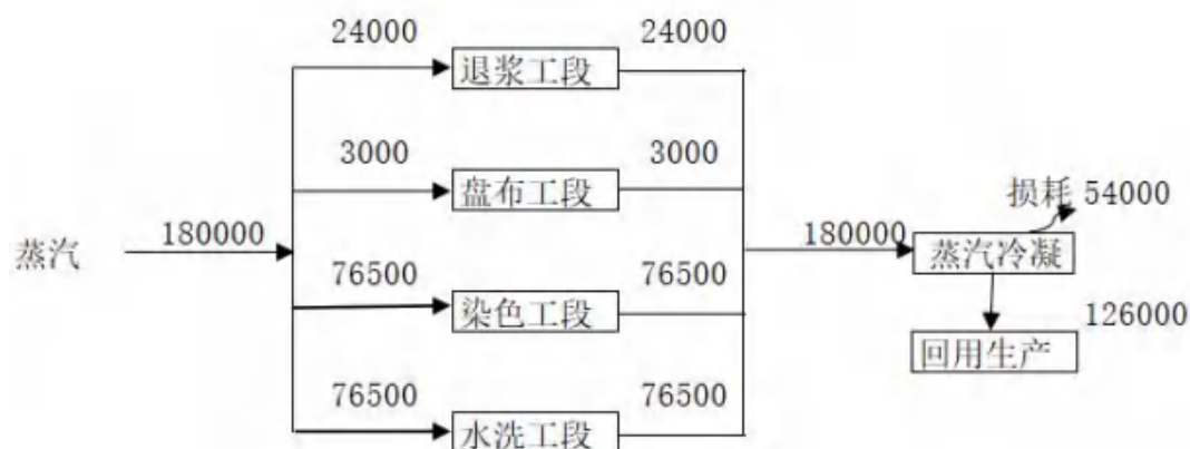
图 3.1-7 现有项目蒸汽平衡图
