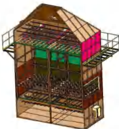
图 7.2-3 静电除油内部结构图
