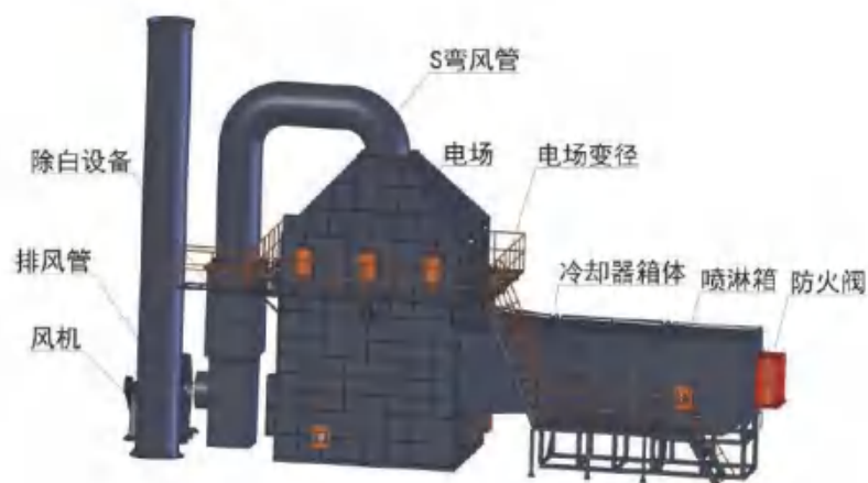
图 7.2-4 “水喷淋+静电净化”设备示意图
